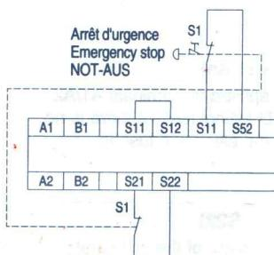
Raccordement de plusieurs boutons arrêt d'urgence
