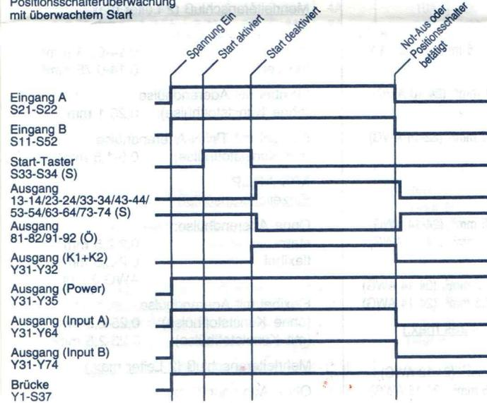
Überwachung einer berührungslos wirkenden Schutzeinrichtung (BWS) mit Halbleiter-Sicherheitsausgängen mit überwachtem Start
