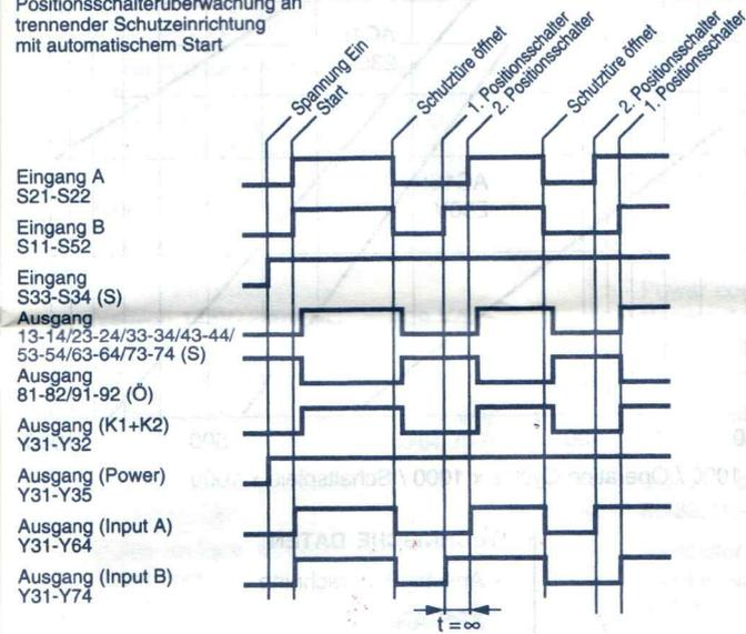
Positionsschalterüberwachung an trennender Schutzeinrichtung mit automatischem Start und Zeitfensterüberwachung
