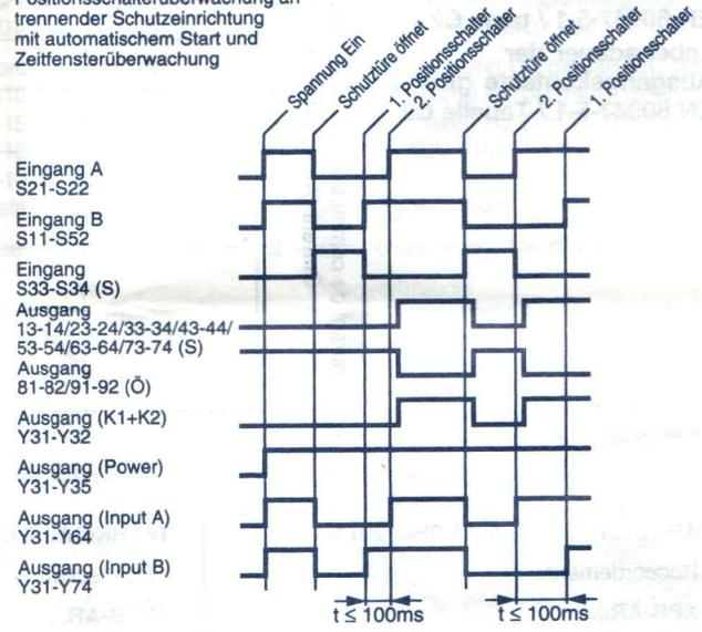
Not-Aus oder Positionsschalterüberwachung mit überwachtem Start
